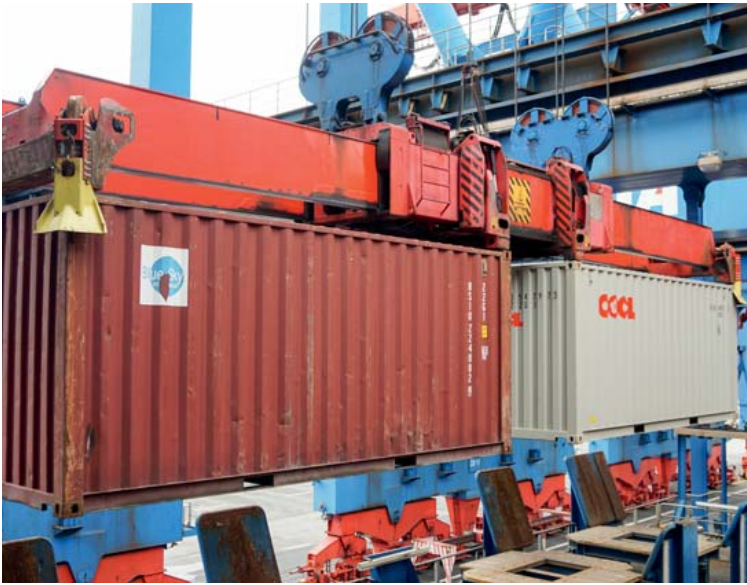
Service Center Altenwerder: Gleich zwei Container hebt dieser Spreader an. An den Ecken sind die Behälter mit Twistlocks befestigt
