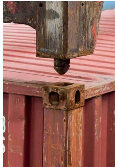
Service Center Altenwerder: Gleich zwei Container hebt dieser Spreader an. An den Ecken sind die Behälter mit Twistlocks befestigt
