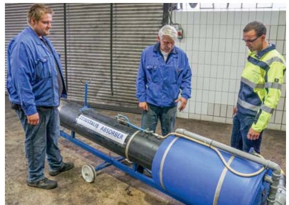
Rußpartikel sind beim J. Müller Breakbulk Terminal kein Problem mehr. Der Feinstaub wird im Absorber mit Wasser gebunden
