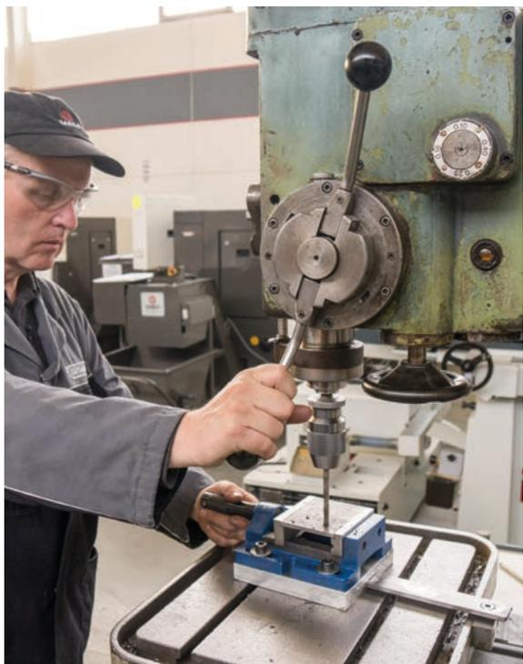
Es müssen keine umständlichen Haltevorrichtungen am Schraubstock angebracht werden
