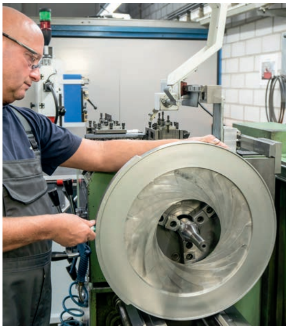
Die geöffnete Schutzblende wird angebracht. In der Mitte gut zu erkennen: das Backenfutter
