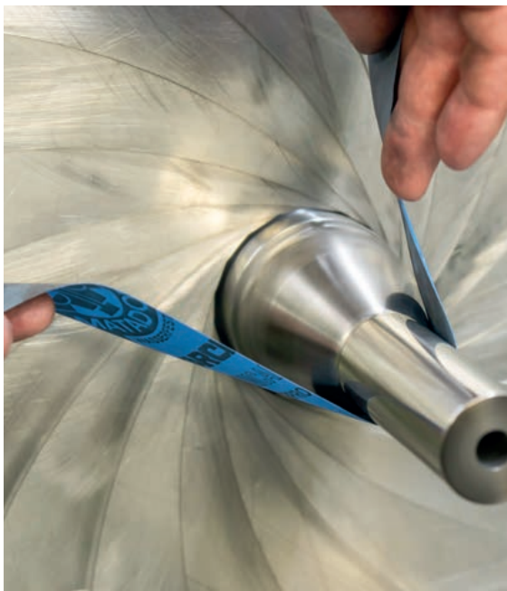
Vor Beginn der Arbeit wird die Blende geschlossen, und das Werkzeug kann sicher poliert werden
