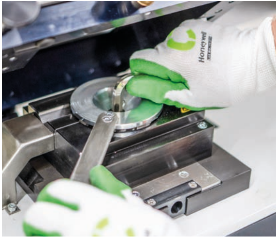
Das Werkzeug in Form einer „Pfanne“ schützt die Hände beim Fräskopfwechsel an der Kantenfräsmaschine
