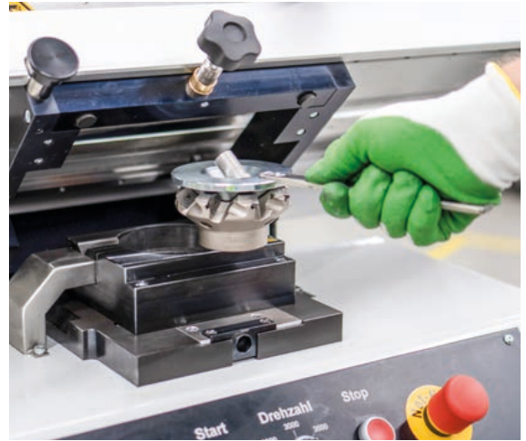
Der Fräskopf kann sicher herausgenommen werden, weil die scharfen Schneiden abgedeckt sind
