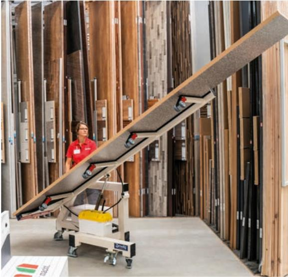
Die Platte wird ohne Kraftaufwand elektrohydraulisch in die Horizontale geschwenkt ...
